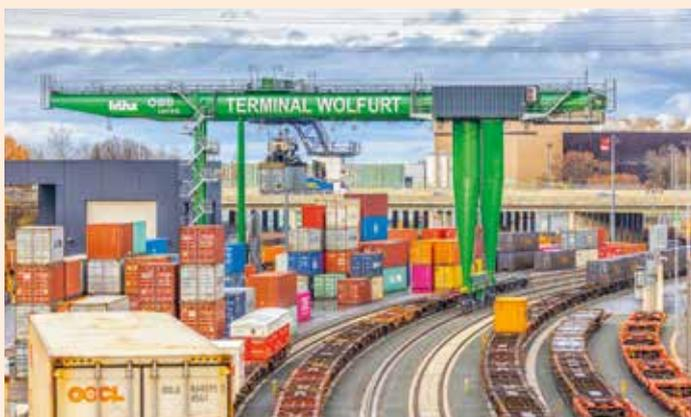
Wolfurt – Intermodal Kran Aerodynamic Double Girder, Tragfähigkeit 41 t, Spurweite 27 m (Foto: Künz GmbH)
